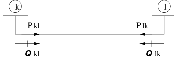
Figura 1.15: Flujo de potencia que fluye por la sección serie en el modelo de la línea
